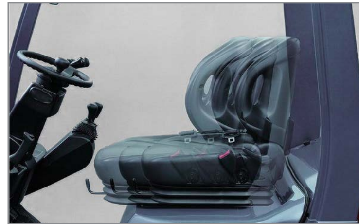
Широкий диапазон регулировки сиденья
