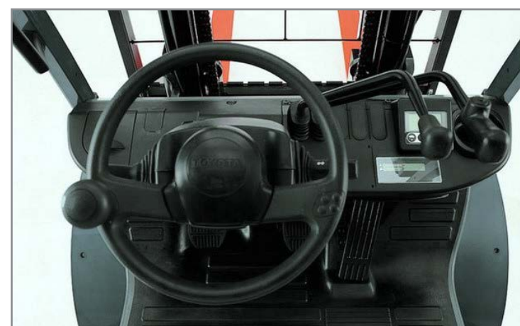
Эргономичное рулевое управление с гидросилителем
